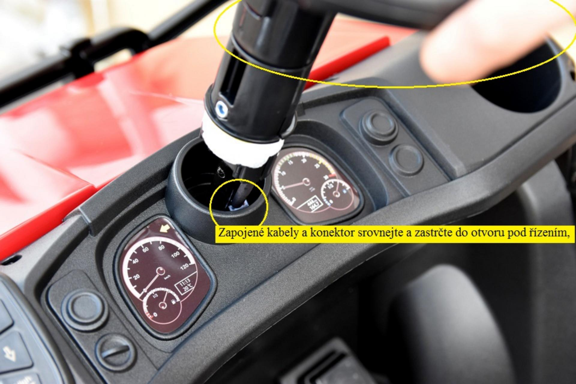
Zapojené kably a konektor srovnejte a zastrčte do otvoru pod řízením.
