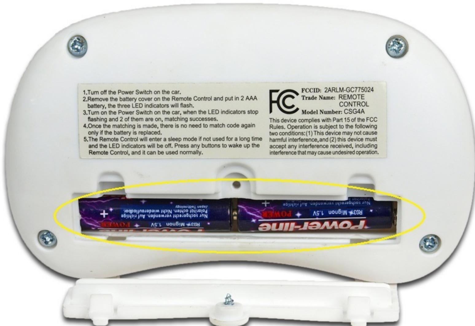
Vložte 2 mikrotužkové baterie R3 AAA, pozor na správnou polaritu + a - !!,
