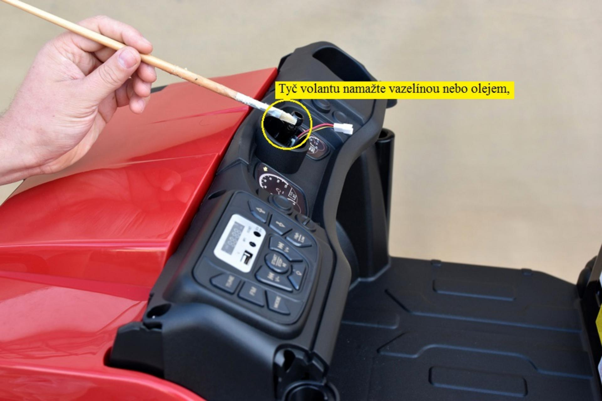
Tyč volantu namažte vazelinou nebo olejem,
